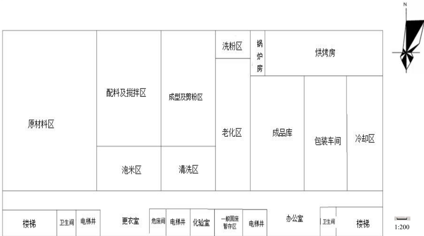
附图 2-2 项目生产车间平面布置图
